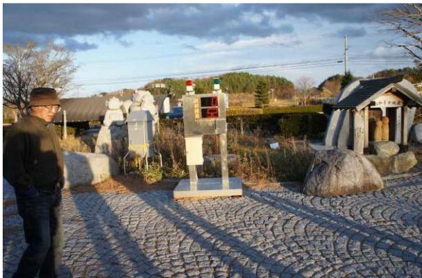
(▼役場前の線量計。電光掲示は上の段が小数点以上、下の段が小数点以下を示す。0.50マイクロシーベルト/時)
